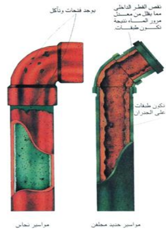
نقص وانسداد القطر الداخلي لمواسير الصرف نتيجة لعدم التطهير والصيانة الدورية
